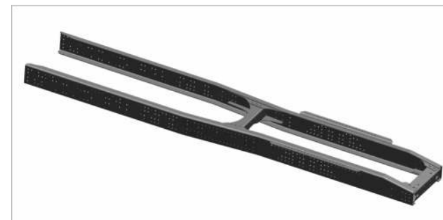
Рама автомобиля из равнополочного швеллера
